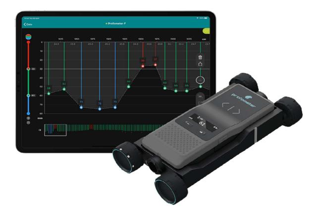
Medidor de Diámetro y Cobertura de Varillas Profometer
