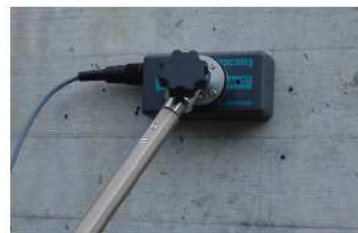
Barra telescópica para sonda universal o ScanCar
